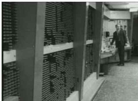
Speicherbank und Konsole des TX-2 Computers
