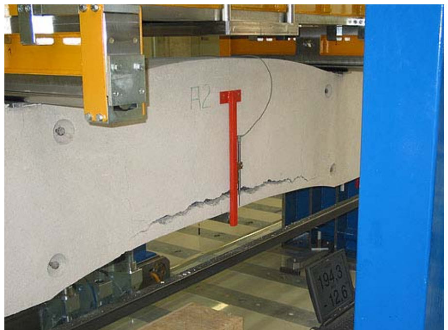
Abb. 9: Bruchform nach Erreichen der Abplatzlast
