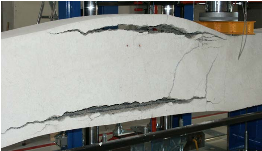
Abb. 11: Bruchbild von Träger Cq bei Erreichen der Biegetraglast
